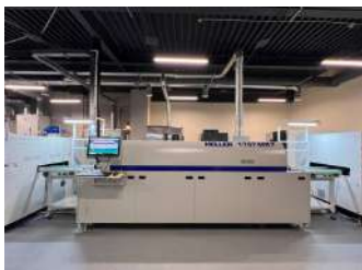
Конвейерная конвекционная печь оплавления припоя
