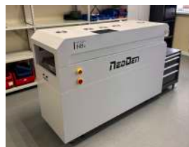
Конвейерная конвекционная печь оплавления припоя
